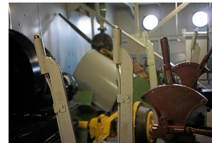
4 Kupplungshebel, 2 Gashebel im Maschinenraum
